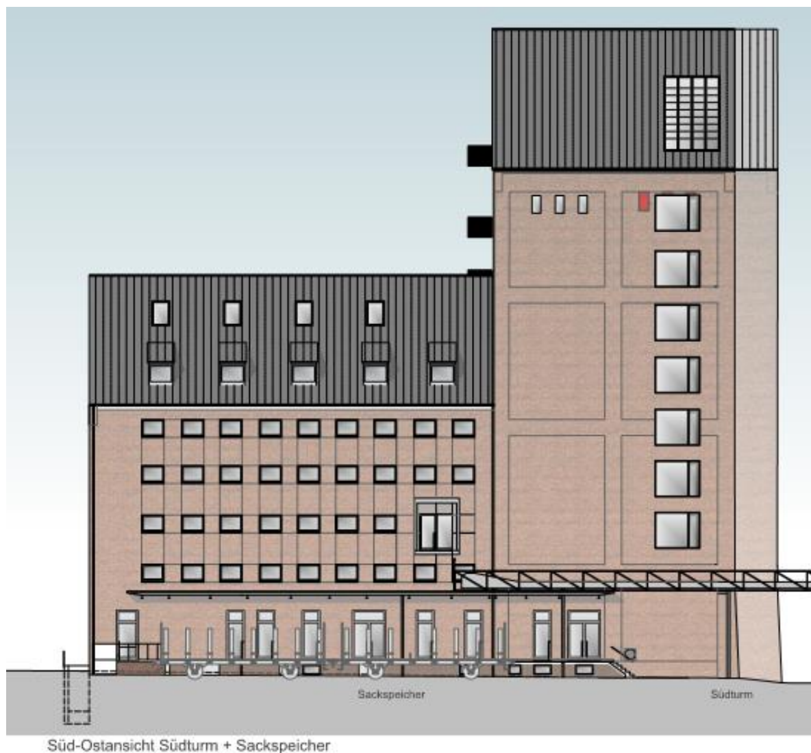
Abbildung 2; Süd-Ostansicht Südurm + Sackspeicher, der Einbau neuer Fenster erfolgt zurückhaltend, das ziegelsichtige Mauerwerk sowie die Dachkonstruktionen und -strukturen bleiben erhalten. Das „Gepräge“ des Objektes bleibt erhalten...
